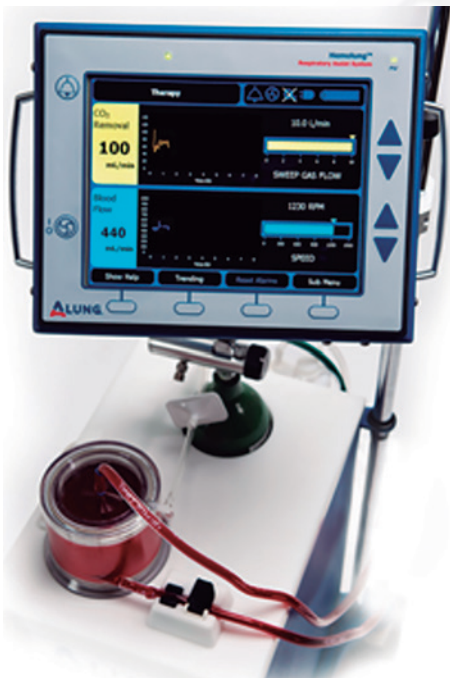
Fig. 50.10. Módulo controlador de control digital con cambio automático oxígeno/aire del sistema HEMOLUNG® RAS.
