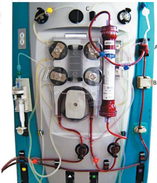
**Fig. 170.7.** Sistema de seguridad. A. Cámara atrapaburbujas, B. Detector de aire, C. Detector de fugas hemáticas.
