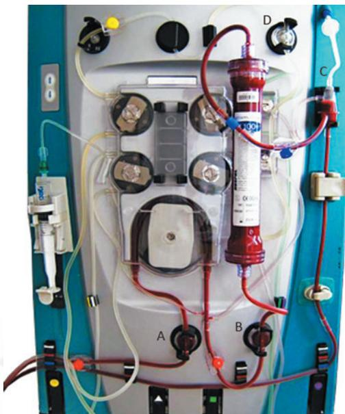
**Fig. 170.6.** Sensores de presión. A. Presión arterial o de entrada, B. Presión de filtro, C. Presión venosa o de retorno, D. Presión del efluente.
