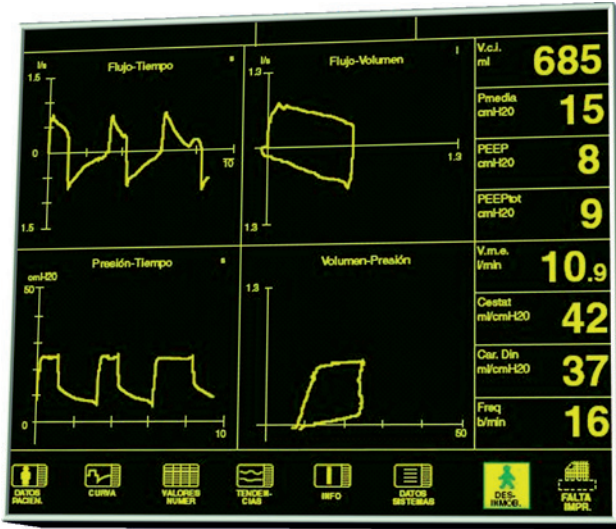
Fig. 35.7. Curvas y bucles presentados por el Servo Screen 390 en un ventilador Servo 300 de Siemens.
